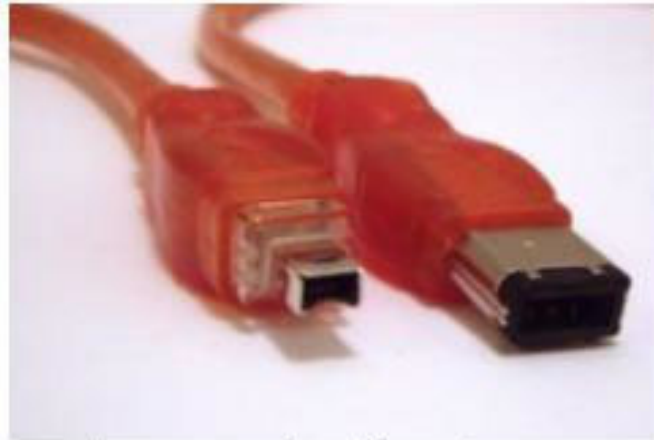
4-pinski (lijevo) i 6-pinski (dsno) FireWire konektori
